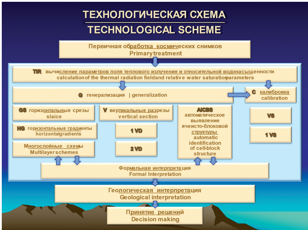
Рисунок 3 – Технологическая схема исследований космических снимков
