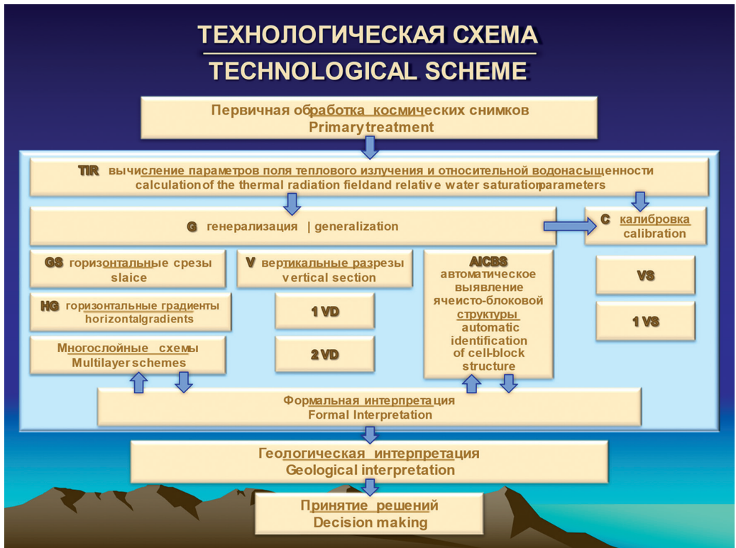
Рисунок 3 – Технологическая схема исследований космических снимков
