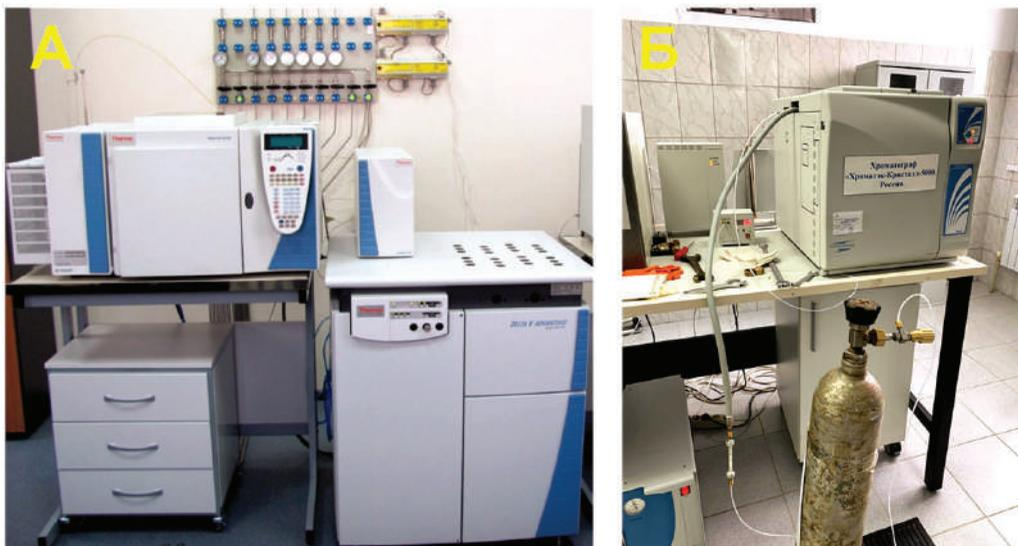
Рисунок 3 – А – изотопный масс-спектретр DELTA V ADVANTAGE Б – аппаратно-программный комплекс на основе хроматографа «Хроматэк Кристалл 5000»
