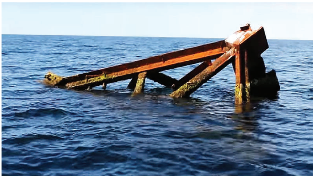
Рисунок 15 – Скифско-Туранская плита. Средний Каспий. Ракушечная-море. Видимая над водой часть юго-западной опоры затонувшей СПБУ «60 лет Азербайджана» (фотокадр из видео, 17 сентября 2012 г.) (источник: https://www.youtube.com/watch?v=LXQIDroDkCo )
