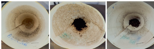
Рисунок 4 – Проверка растворимости солей в метаноле
