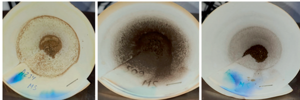
Рисунок 2 – Проверка растворимости солей во взаимном растворителе
