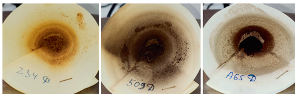
Рисунок 6 – Проверка растворимости солей в дизеле
