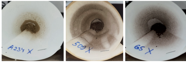
Рисунок 1 – Проверка растворимости солей в ксилоле
