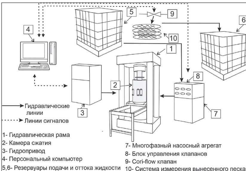
Рисунок 2 – Схема Системы Консолидации Высокого Давления (КВД)
