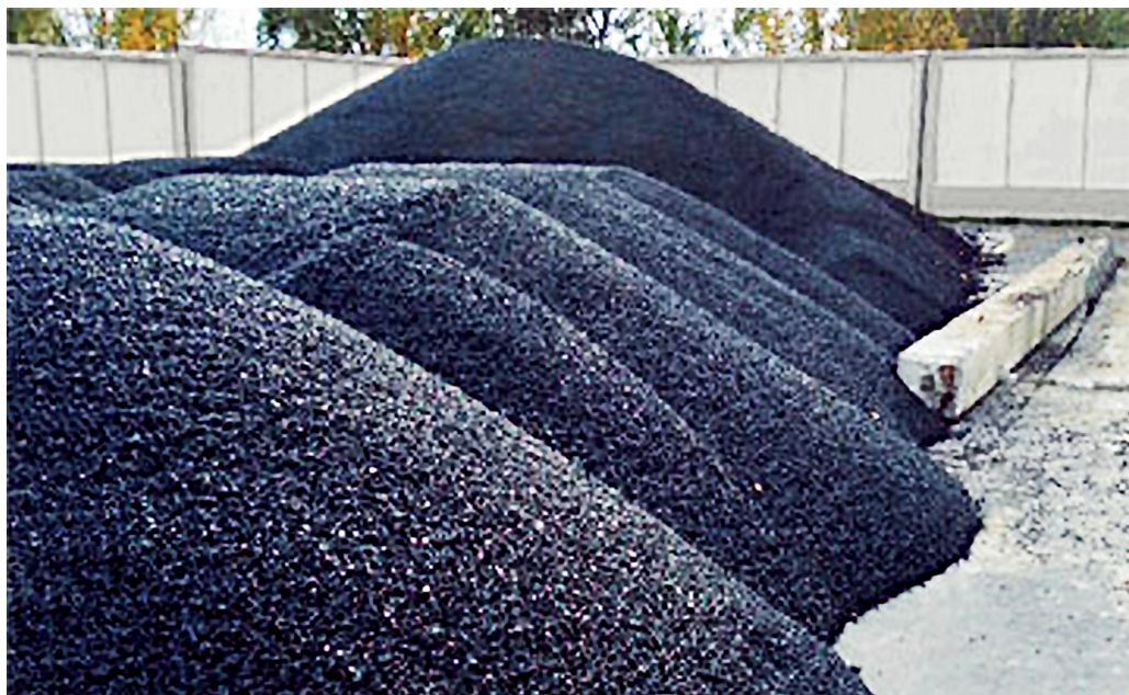
Рисунок 6 – Холодная асфальто-минеральная смесь не слеживается и не схватывается до уплотнения. Транспортируется на дальние расстояния
